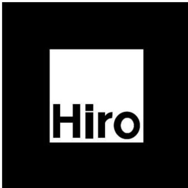
Figura 2.2: Exemplo de marcador usado pelo Artoolkit (Fonte:Kato (2002)).
