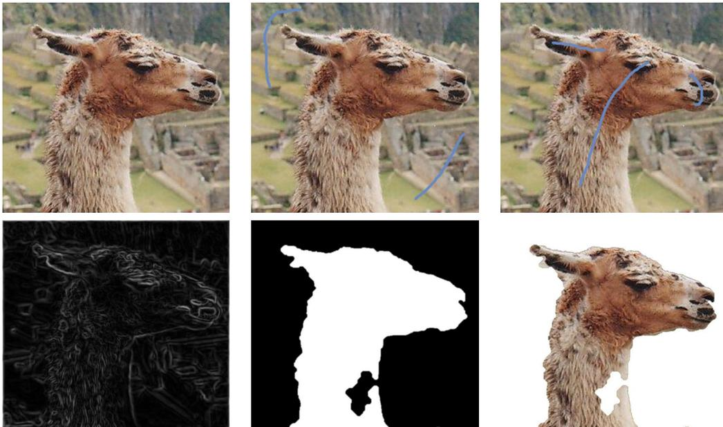
Figura 13: Segmentação de um objeto utilizando  $ng_o = 6$  e  $ng_f = 2$ . A imagem possui 548x510 pixels e 24 bits.
