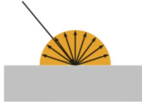
Figura 4: Reflexão difusa ideal. A luz é refletida em todas as direções com a mesma intensidade, independente do ângulo de incidência (JENSEN, 2001).
