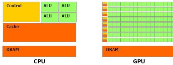
Figura 7: Componentes da CPU e da GPU.
