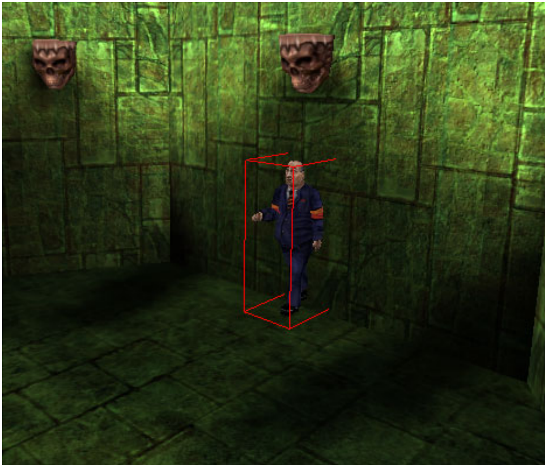
Figura 26: Teste de colisão, ao qual deseja verificar se a geometria envolvente ao objeto intercepta parte do cenário.
